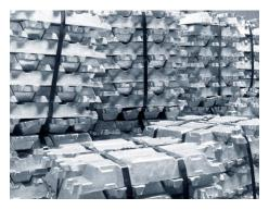
de l'industrialisation. L'aluminium de haute pureté est un matériau critique majoritairement utilisé dans la fabrication des condensateurs et dans la métallisation des circuits électroniques dans les batteries servant au stockage d'énergie. Il importe de mentionner que Nature Alu est le seul producteur nord-américain d'aluminium de haute pureté.
